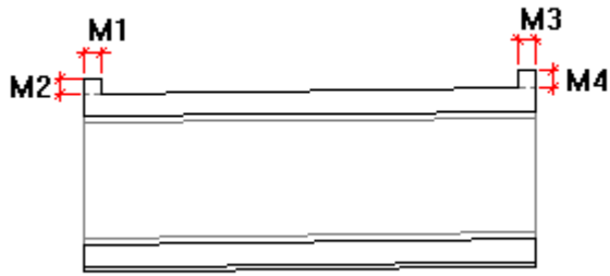
Figura 3.12-1: Definición de muretes de coronación.
