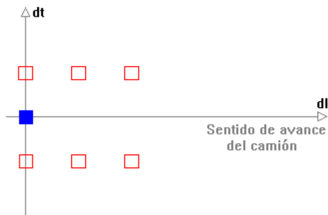
Figura 4.3-1: Esquema del camión de la prueba de carga.
